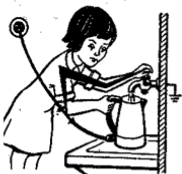
Рис. 9. Нельзя заполнять водой электронагревательные приборы во включенном состоянии
