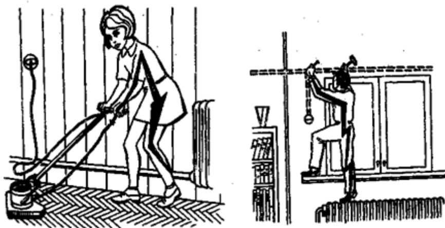
Рис. 6. Нельзя эксплуатировать бытовое электрооборудование, прикасаясь к заземленным металлическим конструкциям
