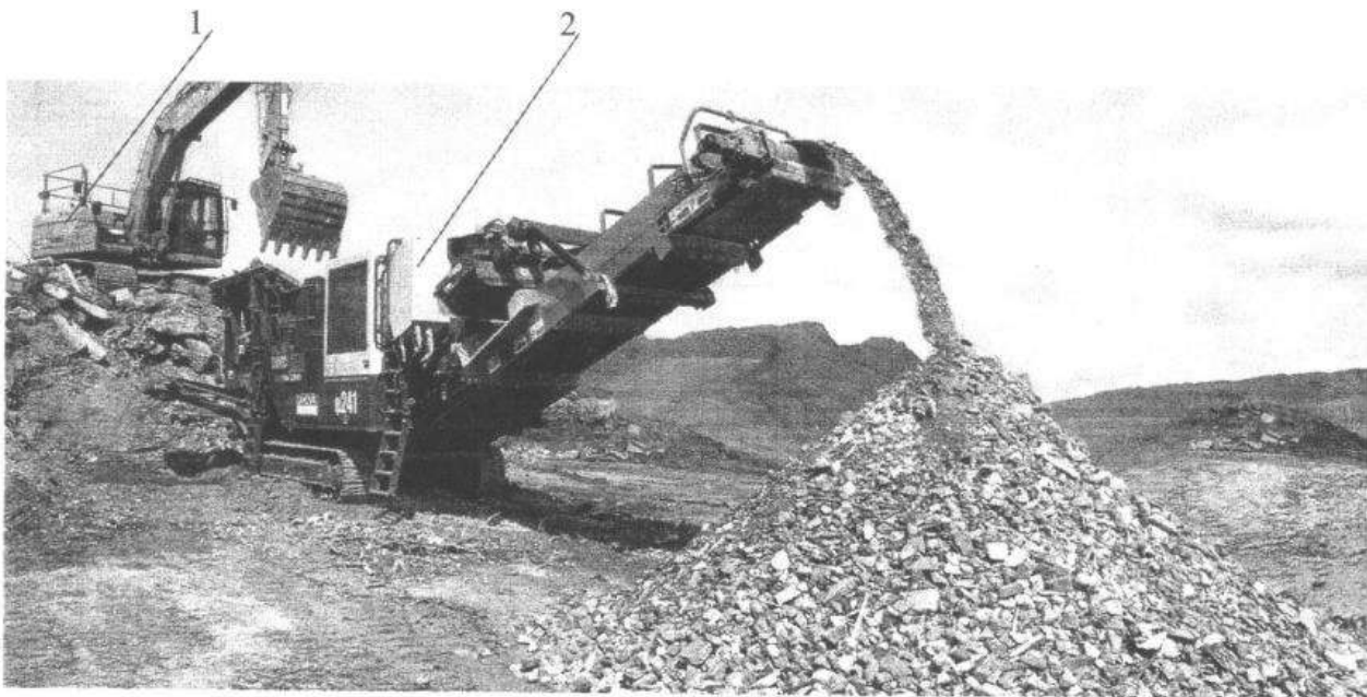
Рисунок 2 Схема осуществления дробления (аналог)
