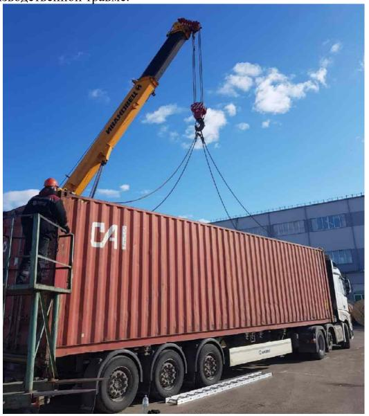
Травмирование пострадавшего произошло при выполнении работ по погрузке контейнера на транспортное средство с использованием автомобильного крана КС-5576K, зарегистрированного в Витебском областном управления Госпромнадзора. Стропальщик после опускания машинистом крана контейнера на платформу автомобиля приставил лестницу к контейнеру и начал подниматься по ней для снятия крюков стропа с проушин контейнера.
